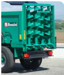
Rulli a coclea da 1200 ÷ 1450 mm con 4 riduttori Beaters with spiral h 1200 ÷ 1450 mm with 4 gear box
