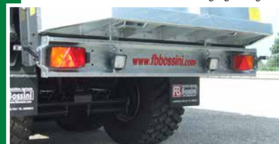
Barra posteriore con fanali standard e fari lavoro Rear bar with standard and working lights
