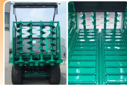
Rulli a coclea da 1520 ÷ 1620 mm con 4 ÷ 5 riduttori Beaters with spiral h 1520 ÷ 1620 mm with 4 ÷ 5 gear box
