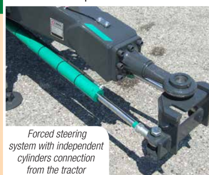
Sistema di sterzata comandata con attacco cilindri indipendente dalla trattrice
