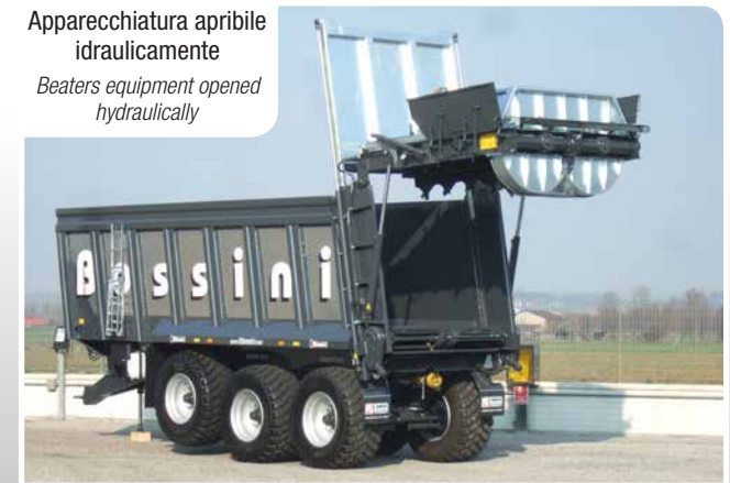
*kit D.U. - Doppio uso: portellone di contenimento + soprasponde cm 60 Double Use: rear door with capacity + extension sides 60 cm
