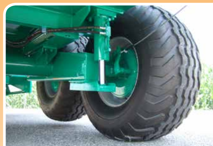
Sollevamento del 1° asse per l'incremento del carico sul gancio di traino, per veicoli a 2 assi Lifting 1 st axle to increase the load on the eyelet, for vehicles with 2 axles
