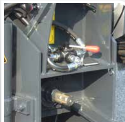
Valvola di inversione rotazione Rotation inversion valve
