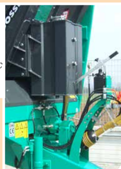
Circuito idraulico indipendente per avanzamento catena Independent hydraulic system for chain motion
