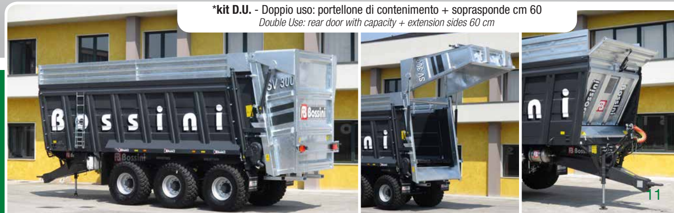
Protezione posteriore ad apertura laterale Rear protection with lateral opening
