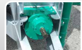
Riduttore Maggiorato da 1000 a 540 giri/min Increased gear box from 1000 to 540 rpm
