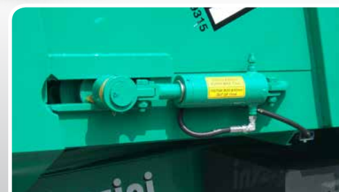
Tendicatena idraulico - Hydraulic tensioner
