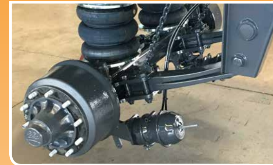
Bi-elemento frenante per servizio + parcheggio Double brake chamber for service + parking
