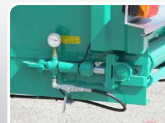
Tendicatena idraulico Hydraulic tensioner
