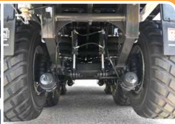
Sollevamento del 1° asse per l'incremento del carico sul gancio di traino per veicoli con sospensione idraulica brevettata Lifting 1 st axle to increase the load on the eyelet for vehicles with Patented hydraulic suspension
