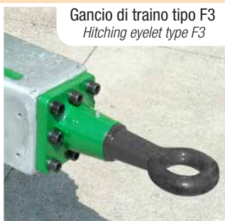
Gancio di traino fisso ø 50 mm Hitching eyelet type fixed ø 50 mm
