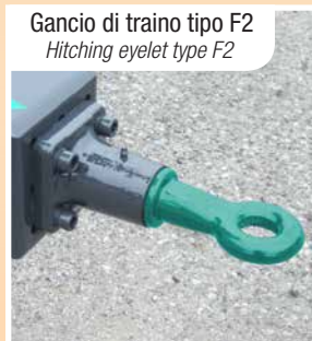
Gancio di traino girevole ø 50 mm Hitching eyelet type swivel ø 50 mm
