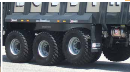
Sollevamento del 1° asse per l'incremento del carico sul gancio di traino per veicoli con sospensione idraulica brevettata Lifting 1 st axle to increase the load on the eyelet for vehicles with Patented hydraulic suspension
