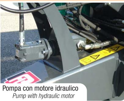
Pompa con motore idraulico
