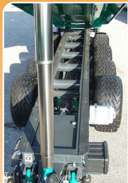
Telaio in trave industriale con traverse di irrigidimento a sezione circolare
