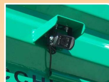
Telecamera ad infrarossi con monitor LCD sulla trattore
