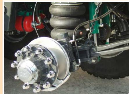
Frenatura a disco con pinza per alte velocità
