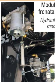
Modulatore di frenata idraulico
