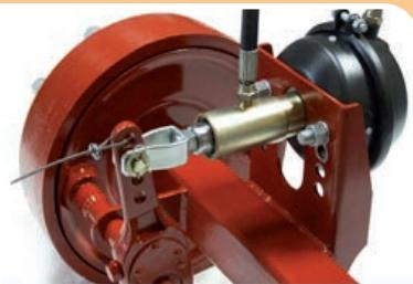
Frenatura mista pneumatica + idraulica
