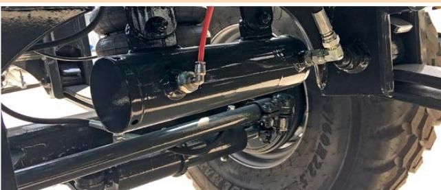
Correttore di sterzata con cilindro idro-pneumatico
