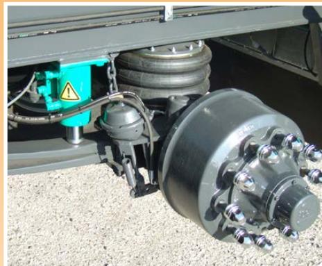
Stabilizzatori idraulici posteriori
