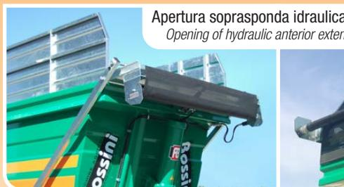
Apertura soprasponda idraulica anteriore
