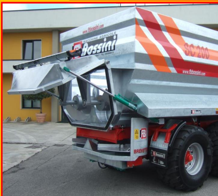
**Sponda posteriore idraulica a tenuta stagna con guarnizione a doppio labbro; costituita da struttura robusta atta al dosaggio del materiale convogliato sulle ventole. N°2 ventole a rotazione idraulica che garantiscono uno spargimento uniforme sul terreno di circa 20 metri. Possibilità di rientro idraulico delle ventole posteriori per consentire lo scarico senza la distribuzione.**
