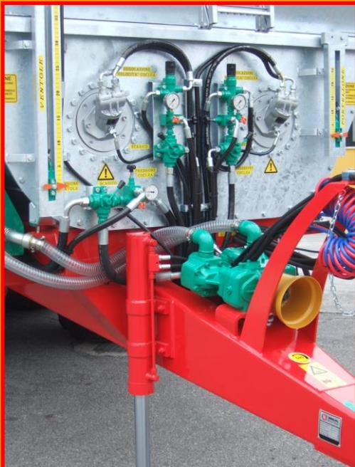
**Movimentazione idraulica di tutti gli organi in rotazione con possibilità di regolazione della velocità e dello sforzo in funzione del prodotto da distribuire.**
