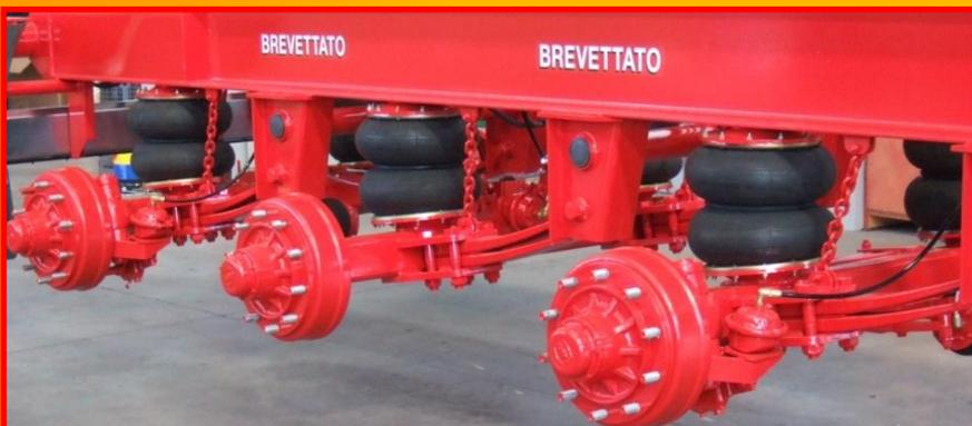
**Sospensione idraulica brevettata su torpress, consente una distribuzione omogenea del peso sulle ruote ed elimina il beccheggio in velocità.**
