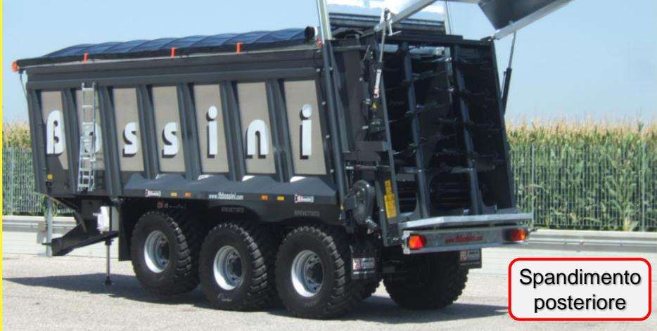
L'altro tipo di macchine sono i **rimorchi** a cassone semisferico con portata da 8 m<sup>3</sup> a 65 m<sup>3</sup> e con optional personalizzabili:
