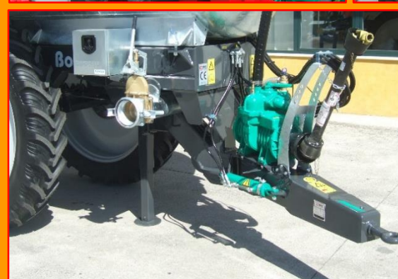
Timone snodato completo di cilindro idraulico comandato dalla trattore, oppure collegato alla barra sollevamento e tiranti regolabili (per gancio di traino basso e carreggiata stretta) Pivoting drawbar complete with hydraulic cylinder controlled by the tractor, or attached to the lifting bar and adjustable tie rods (for down eyelet and narrow distance between the tires)
