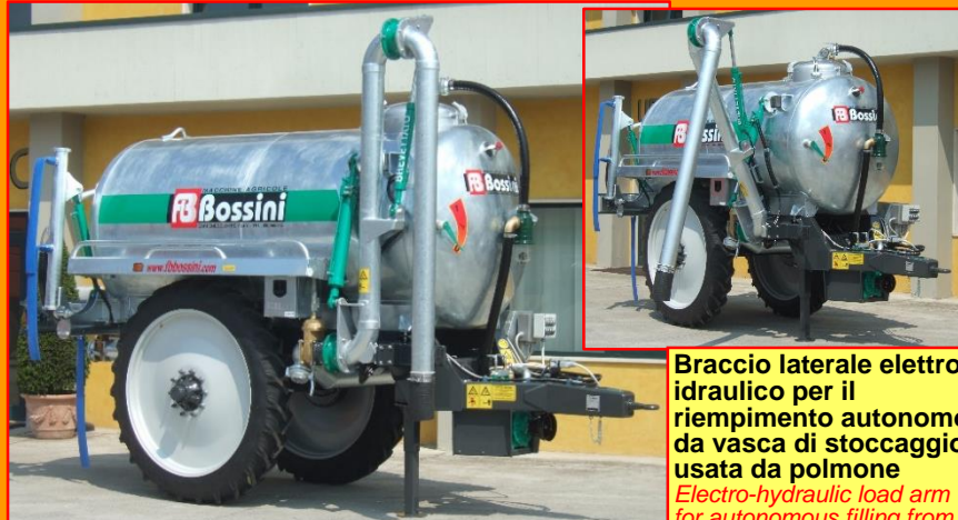
Sistema di riempimento autonomo tramite cono in gomma da 8" e braccio idraulico con giunto sferico in testa del carro botte "navetta" per l'approvvigionamento del digestato o liquame (Optional) Independent filling system through rubber cone 8" and hydraulic arm with ball joint at the end of the big slurry spreader for the supply of the liquid digestate or slurry (Optional)
