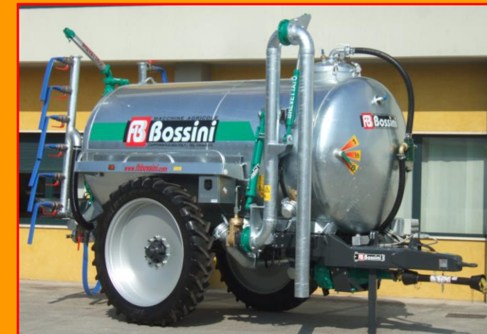
Carro Botte da lt. 8.000 ÷ 10.000 con ruote 340/85 R48 (Ø 1800 x 345 mm) Slurry Spreader of 8.000 ÷ 10.000 lt with tires 340/85 R48 (Ø 1800 x 345 mm)
