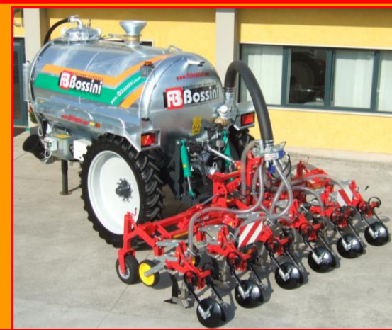
B1 con Interratore ad ancore indipendenti, con movimento a parallelogramma. Molle o dischi per copertura del solco B1 with injector to independent anchors, with parallelogram movement. Springs or discs for the cover of groove
