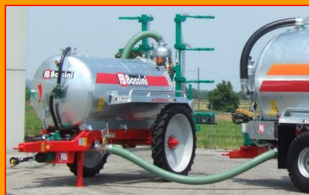
Sistema di riempimento manuale con giunti rapidi, tramite tubazione flessibile. Manual filling system with quick links, through flexible pipe.
