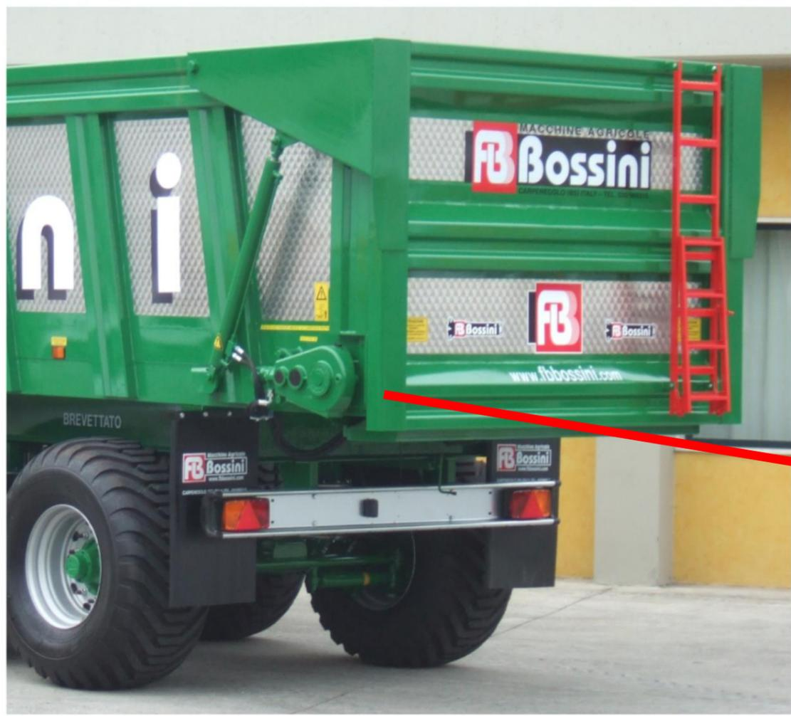
**N°2 Motoriduttori idraulici
