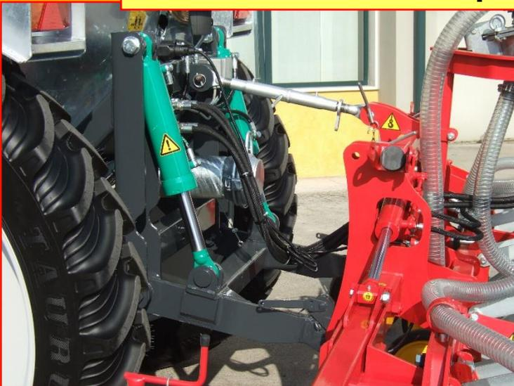
Sollevatore idraulico che permette l'aggancio di varie attrezzature. Possibilità di utilizzare il getto spargitore tradizionale.
