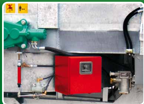
Modulatore di frenata idraulico Hydraulic braking modulator
