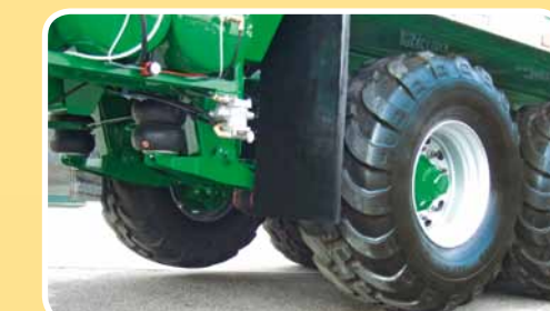
Sistema di sollevamento dell'asse Lift axle system
