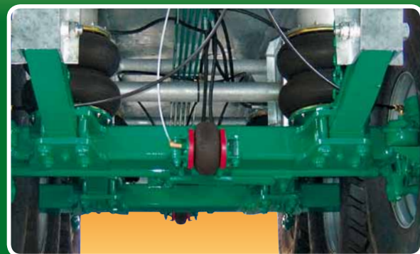
Correttore pneumatico di sterzata Pneumatic tire steering correction
