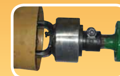
Trasmissione con ruota libera Transmission with free wheel
