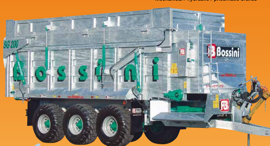
Soprasponde per materiali voluminosi (40m³) Over side for voluminous materials (40m³)
