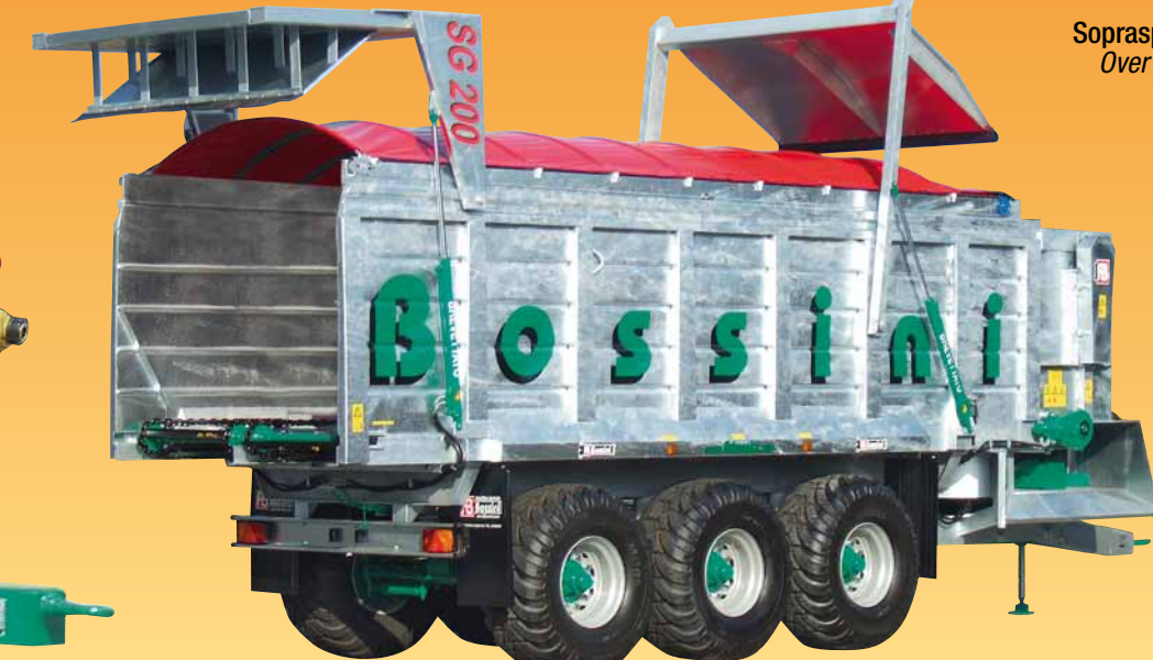
Sponda idraulica per scarico posteriore Rear hydraulic door for unload
