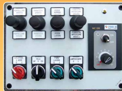
Comandi elettroidraulici con regolatore della velocità del tappeto Electro-hydraulic controls with floor speed controller
