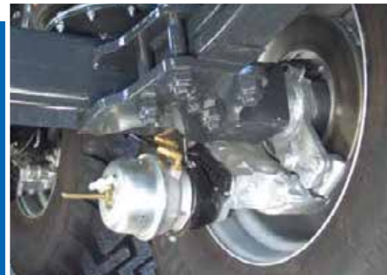
Bi-elemento frenante per servizio + parcheggio Double brake chambers for service + parking
