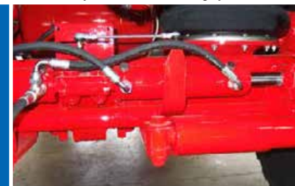
Cilindro di comando assale con trasduttore angolare per sistema di sterzata comandata elettro-idraulica Control cylinder axle with angular transducer for electro-hydraulic forced steering system
