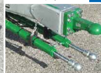
Cilindri di comando con attacchi a calotta K50 Forced steering cylinders with coupling K50
