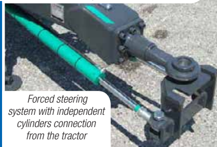
Sistema di sterzata comandata con attacco cilindri indipendente dalla trattrice Forced steering system with independent cylinders connection from the tractor
