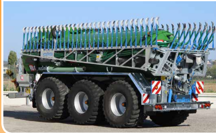
Carro Botte a 2 o 3 assi con ruote maggiorate per la distribuzione in campo su qualsiasi terreno Slurry spreader with 2 or 3 axles and increased tyres for the distribution on every field
