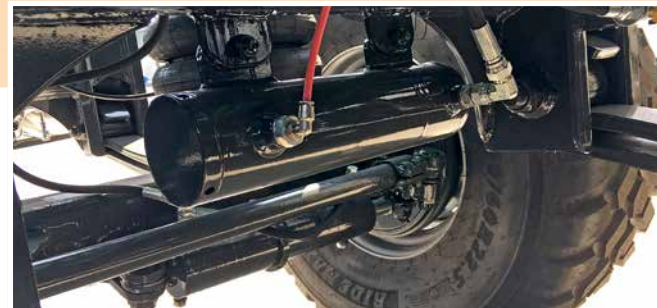
Cilindro di comando assale con trasduttore angolare per sistema di sterzata comandata elettro-idraulica Control cylinder axle with angular transducer for electro-hydraulic forced steering system
