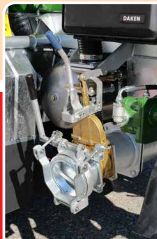
Aggancio rapido con giunto Perrot Quick coupling with Perrot system
