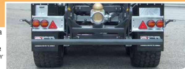
Gancio F3 con 2 posizioni Hitching eyelet type F3 with 2 position
