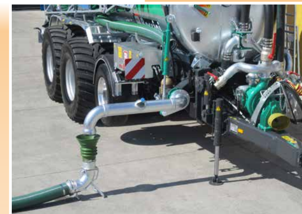
Pompa volumetrica a lobi con separatore oppure tritratore Volumetric rotary lobes pump with filter or cutter system
