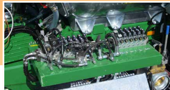
Gruppo elettroidraulico con load sensing Load sensing electrohydraulic system
