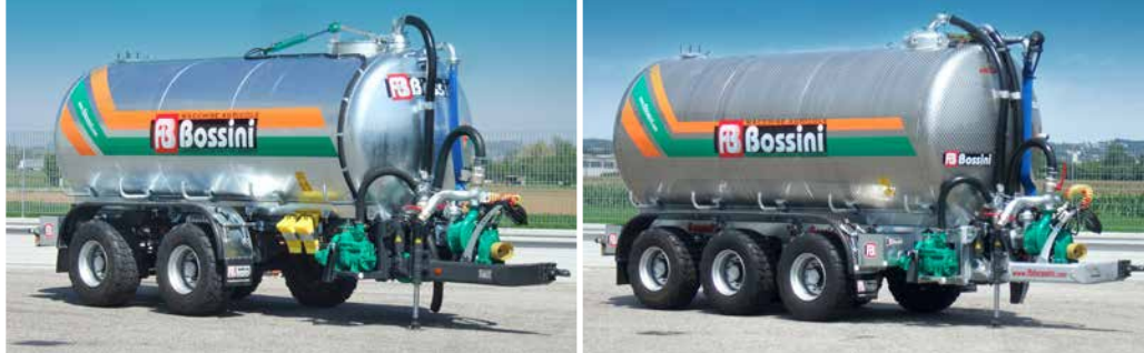
Carro Botte a 2 o 3 assi per trasporto stradale con decompressore idraulico per vuoto e pompa centrifuga a cardano ad alta pressione
