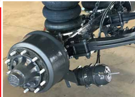
Bi-elemento frenante per servizio + parcheggio Double brake chamber for service + parking
