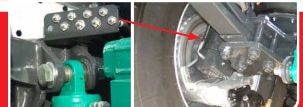
Lubrificazione centralizzata degli assali autosterzanti Centralized lubrication of self-steering axles
