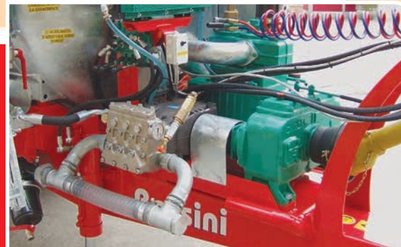
Pompa a pistoni per spurgo pozzi neri con portata da 100 l/min alla pressione di 200 bar Piston pump for washing with flow of 100 l/min to the pressure of 200 bar
