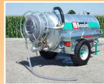
Naspo manuale per aspirazione con tubazione ø 60 mm Manual hose reel for suction with pipe ø 60 mm
