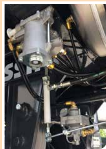
Sistema di sterzata comandata con attacco cilindri indipendente dalla trattrice Forced steering system with independent cylinders connection from the tractor
