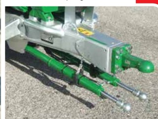
Cilindri di comando con attacchi a calotta K50 Forced steering cylinders with coupling K50
