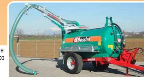
Naspo con tubazione da 1" e lunghezza 10 m con lancia lavaggio. Naspo con tubazione da 3/8" e lunghezza 18 m con lancia mitra. Hose reel with pipe 1" and length of 10 mt with washing lance. Hose reel with pipe 3/8" and length of 18 mt with mitra lance.
