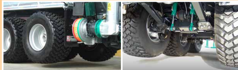
Sollevamento del 1° asse per l'incremento del carico sul gancio di traino, per veicoli a 3 o 4 assi Lifting 1st axle to increase the load on the eyelet, for vehicles with 3 or 4 axles
