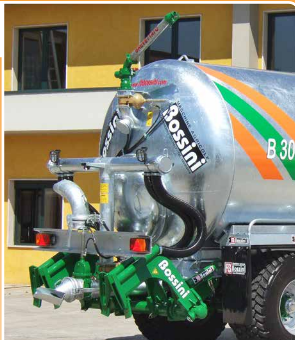
Interratore a 4 ancore snodate con: - interasse lavoro di 0,7 m - tubi flessibili Ø 100 mm
