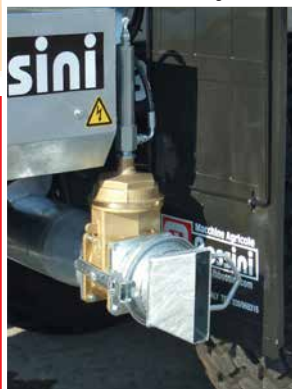
Diffusore di spandimento su saracinesca idraulica laterale con gittata di 10 m Spreader tool on hydraulic lateral valve with 10 m range
