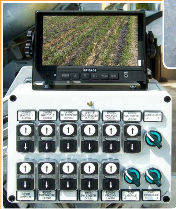
Manipolatore elettro-idraulico con luci di segnalazione Electro-hydraulic control with signal lights
