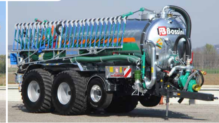
Naspo manuale per aspirazione con tubazione ø 60 mm Manual hose reel for suction with pipe ø 60 mm
