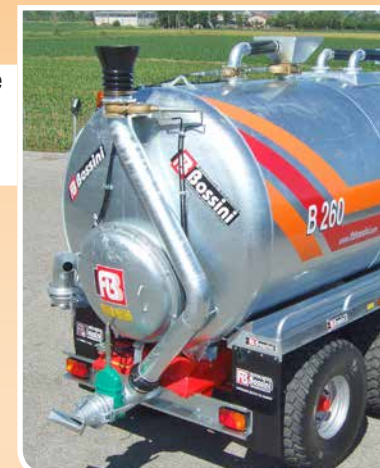
Cono in gomma per aspirazione da Terragator/Xerion Rubber cone for suction from Terragator/Xerion
