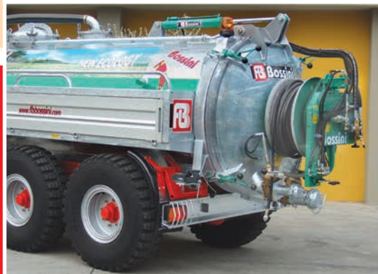
Naspo idraulico a bandiera con tubazione da 3/4" e sonda Hydraulic hose reel with rotation system, pipe 3/4" and nozzle
