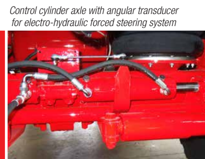
Cilindro di comando assale con trasduttore angolare per sistema di sterzata comandata elettro-idraulica Control cylinder axle with angular transducer for electro-hydraulic forced steering system
