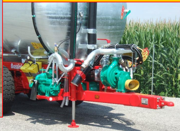
Timone fisso rinforzato abbinato a valvola livellatrice a 5 posizioni della sospensione pneumatica Fixed drawbar reinforced combined with leveling valve with 5-position of the air suspension Feste Deichselfederung mit verstärktem Niveauregelventil mit 5 Positionen der Luftfederung
