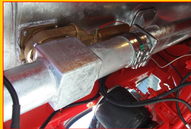
Collettore di aspirazione della pompa centrifuga con n°2 saracinesche pneumatiche comandate da attuatore (possibilità di scarico anche se la macchina è in pendenza) – n°2÷3 saracinesche (posteriore e laterali) di aspirazione collegate al collettore Intake manifold of the centrifugal pump with nr.2 valves controlled by pneumatic actuator (ability to discharge even if the machine is on a slope) – nr.2 ÷ 3 valves (back and sides) connected to the intake manifold Ansaugkrümmer der Kreiselpumpe mit 2 Ventile, durch pneumatischen Aktuator gesteuert (Fähigkeit zu entladen auch wenn die Maschine abfallend ist); 2÷3 Ventile (hinten und seitlich), die mit dem Ansaugkrümmer verbunden sind
