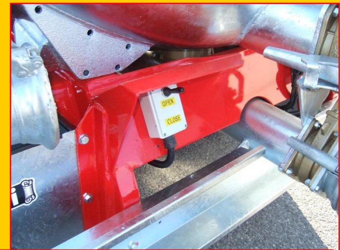
Collettore di aspirazione della pompa centrifuga con n°2 saracinesche pneumatiche comandate da attuatore (possibilità di scarico anche se la macchina è in pendenza) – n°2÷3 saracinesche (posteriore e laterali) di aspirazione collegate al collettore Intake manifold of the centrifugal pump with nr.2 valves controlled by pneumatic actuator (ability to discharge even if the machine is on a slope) – nr.2 ÷ 3 valves (back and sides) connected to the intake manifold Ansaugkrümmer der Kreiselpumpe mit 2 Ventile, durch pneumatischen Aktuator gesteuert (Fähigkeit zu entladen auch wenn die Maschine abfallend ist); 2÷3 Ventile (hinten und seitlich), die mit dem Ansaugkrümmer verbunden sind
