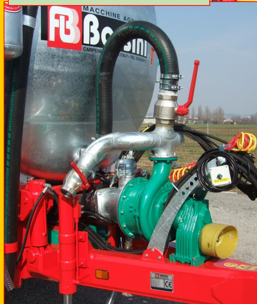
Pompa centrifuga da 5.000 l/min a 10 bar di pressione per il riempimento e lo svuotamento del serbatoio – possibilità di miscelare il prodotto durante il trasporto Centrifugal pump 5,000 l/min at 10 bar pressure for filling and emptying the tank - can mix the product during transport Kreiselpumpe von 5000 Liter pro Minute bei 10 bar Druck bei Befüllung und Entleerung. Während des Transports, Fähigkeit des Streuguts zu mischen
