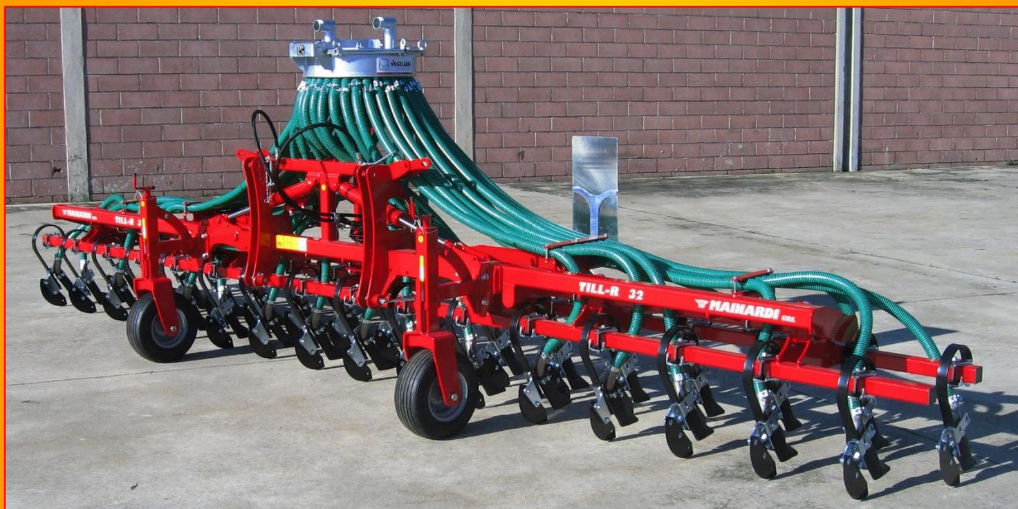
**Barra di iniezione del liquame su prati stabili con minima profondità di lavoro, senza rovinare la coltura e con basso impatto ambientale: minori passate sul terreno ed uniformità di spandimento.**
