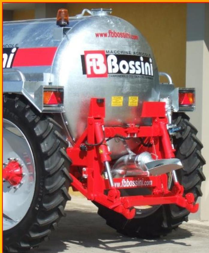
**Sollevatore idraulico che permette l'aggancio di varie attrezzature. Possibilità di utilizzare il getto spargitore tradizionale.**
