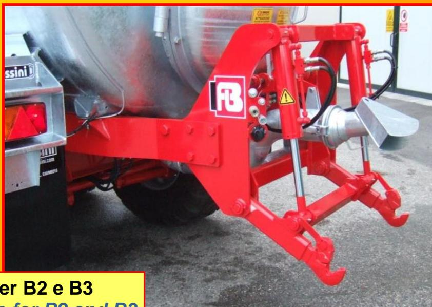
**Sollevatore idraulico per B2 e B3**
