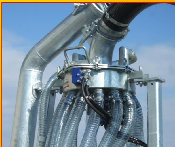
**Distributore idraulico con uscite Ø 60 mm per dosare regolarmente il liquido in ogni uscita**
