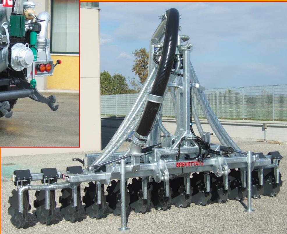
**Possibilità di utilizzare il getto spargitore tradizionale senza smontare l'attrezzatura**
