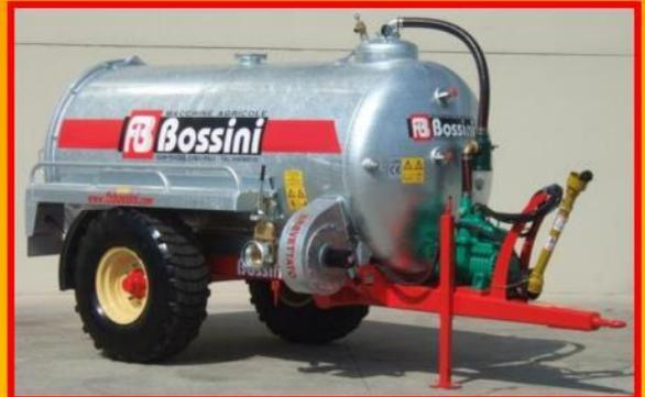
Centrifuga motorizzata idraulica sul braccio di aspirazione + Centrifuga a cardano anteriore per scarico
