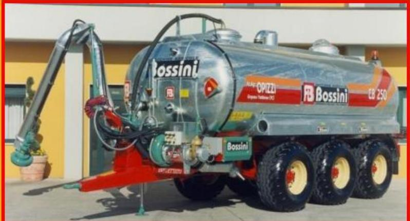
Decompressore per vuoto motorizzato idraulico + pompa centrifuga a cardano
